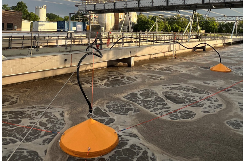
Abbildung 1: Aufbau des EmiCoLite Systems am untersuchten Belebungsbecken
